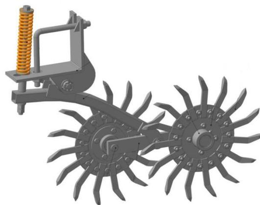
Борона - мотыга ротационная предназначена для довсходового и послевсходового боронования посевов зерновых, пропашных и технических культур. Применяется для борьбы с сорняками, разрушения корки, рыхления поверхности поля, насыщения почвы воздухом, сохранения влаги, подготовки почвы под посев. Агрегат эффективно и равномерно разрыхляет почву, не повреждая при этом растения, имеет высокую раму, что позволяет проводить междурядную обработку в более поздние сроки вегетации.
